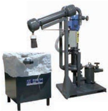
Automatic Sludge Removal Equipment with or without Submerge Cutting System Sistema di Evacuazione Automatico con o senza Sistema di Taglio Sommerso
