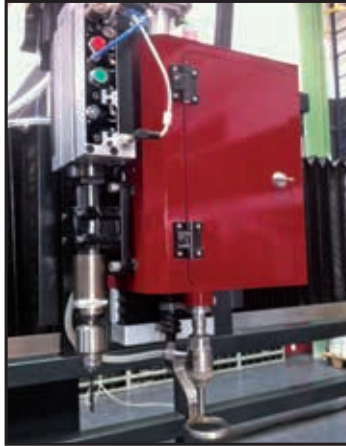
Pre-piercing and Counter sink device Trapano meccanico per la preforatura e la bisellatura dei fori
